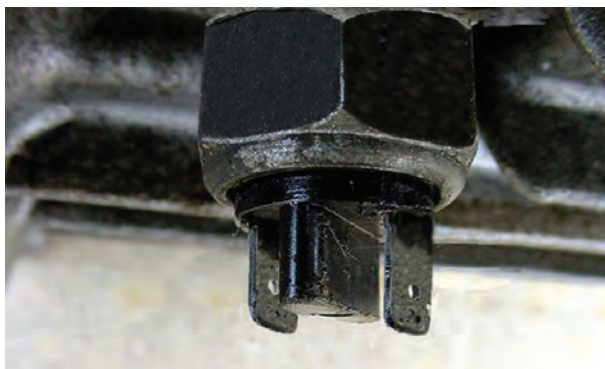
شکل ۱-۱۰۳- سوئیچ دنده عقب نصب شده در روی پوسته جعبه دنده
