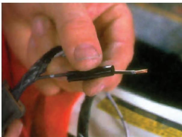
شکل ۱-۱۴۸ – تیوب عایق کاری
