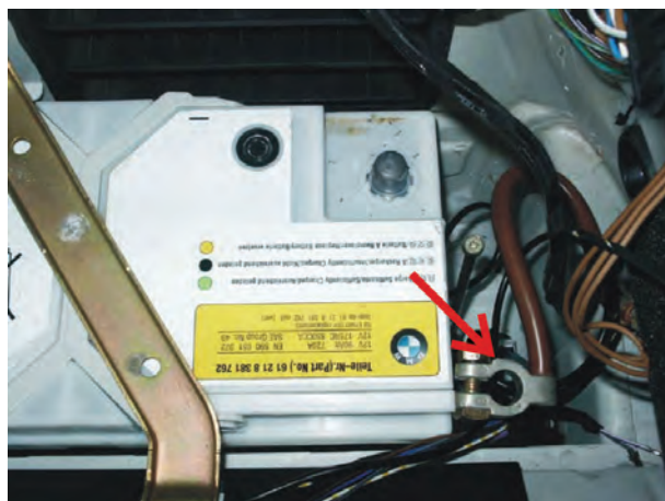
شکل ۳۵-۱- جدا کردن بست اتصال کابل بدنه‌ی باتری
