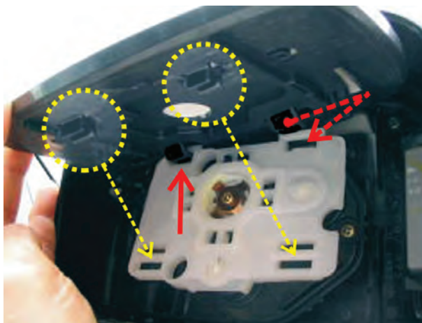
شکل ۱۶۲-۲ زائده‌ها و خارهای اتصال آیین به صفحه‌ی زیرین
