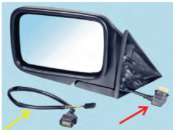
شکل ۱۵۷-۲- آینه‌ی الکتریکی خودرو
