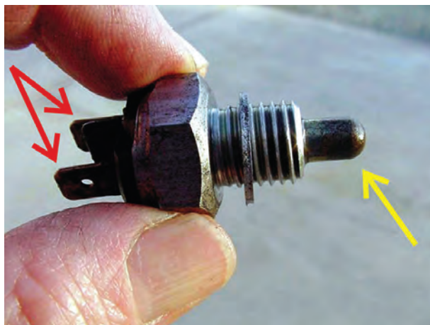
شکل ۱۰۴- پلانجر و ترمینال‌های سوئیچ دنده عقب
