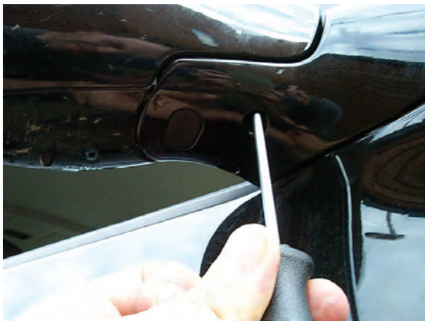
شکل ۲-۱۷۶ بازکردن پیچ روی پایه ی بیرونی آینه
