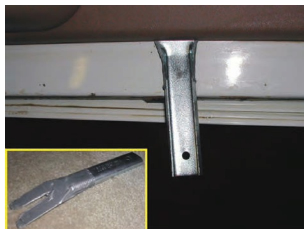
شکل ۲-۳۵- اهرم خاردرآر و نحوه‌ی استفاده از آن
