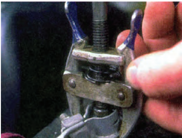
شکل ۱-۸۹- باز کردن بست اتصال بدنه‌ی باتری
