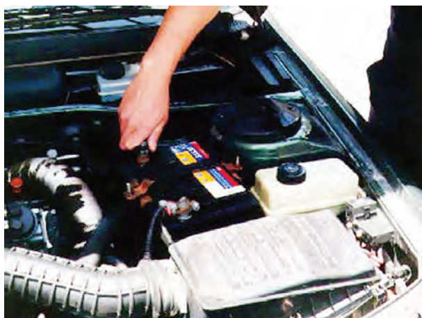
شکل ۱۶۴-۲ باز کردن کابل اتصال بدنه‌ی باتری
