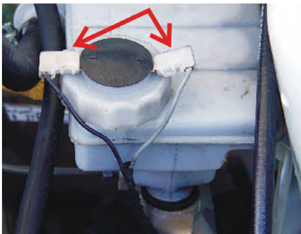
شکل ۲۰۳-۱ سوکت های اتصال پلاتین ها
