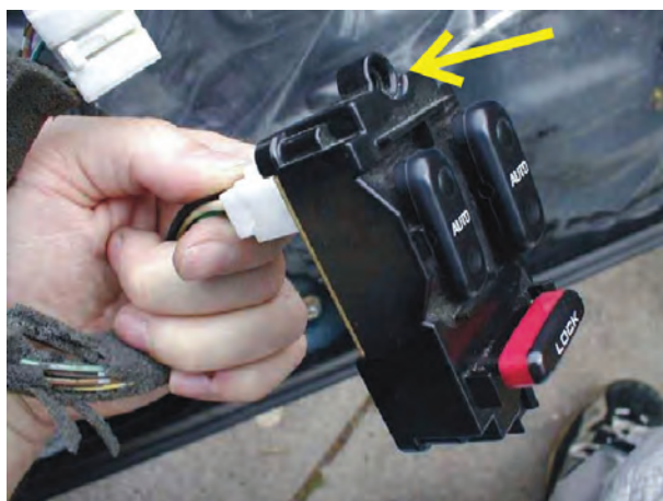
شکل ۱۴۴-۲- محل و پیچ اتصال سوئیچ به بدنه‌ی در
