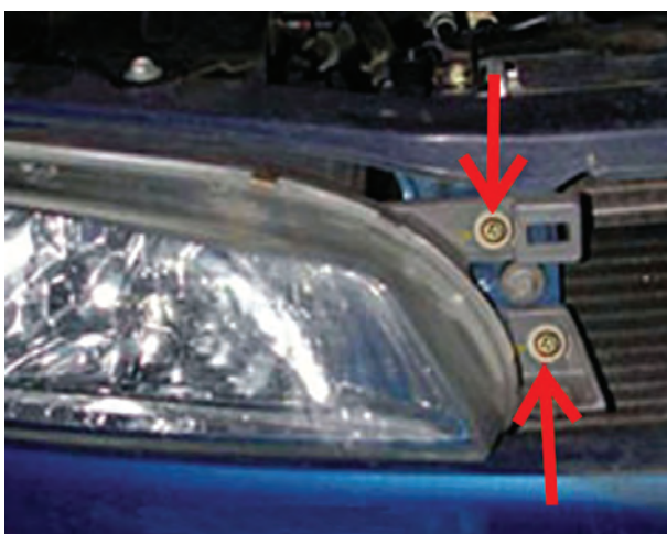
شکل ۱-۴۰- پیچ‌های نگه‌دارنده‌ی چراغ‌های بزرگ جلو
