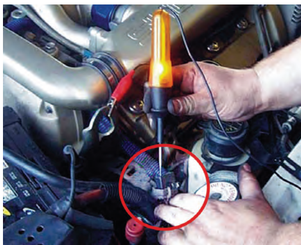
شکل ۱۴۵-۱ آزمایش برقراری جریان مدار چراغ‌های روشنایی
