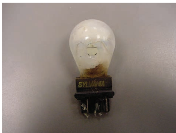
شکل ۱۴۱- اثر عوامل فیزیکی در معیوب شدن لامپ
