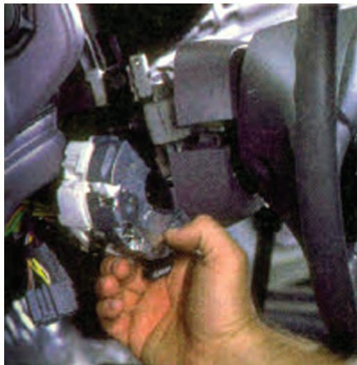
شکل ۹۶-۱- خارج کردن سوئیچ روشنایی از محل خود
