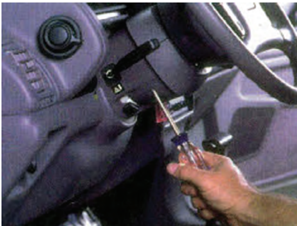
شکل ۱-۹۰- باز کردن پیچ‌های قاب سوئیچ روشنایی
