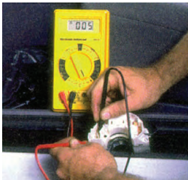
شکل ۹۷-۱- آزمایش سوئیچ روشنایی
