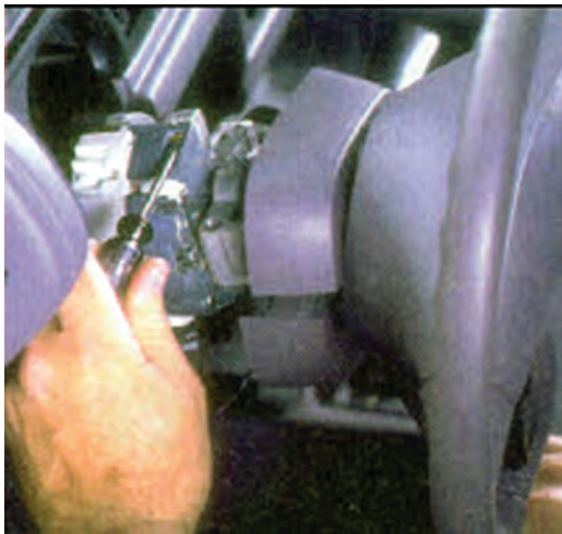
شکل ۹۵-۱- باز کردن پیچ بدنه ی سوئیچ روشنایی
