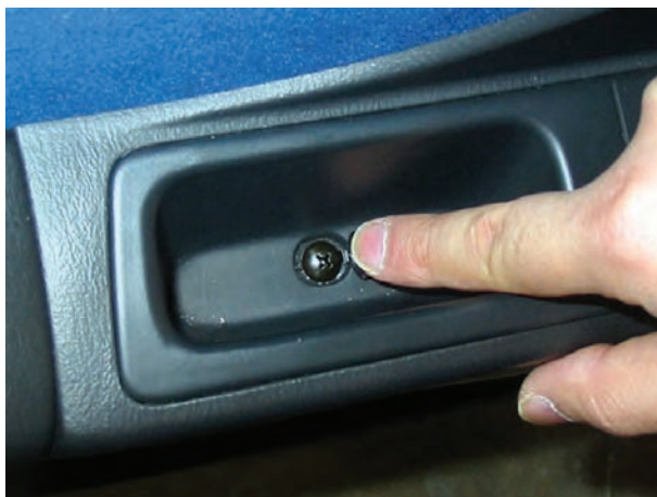
شکل ۱۸۲-۲ پیچ اتصال قاب سوئیچ به بدنه
