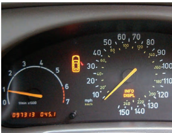
شکل ۲۱۳-۱- چراغ خطر بازبودن درهای خودرو
