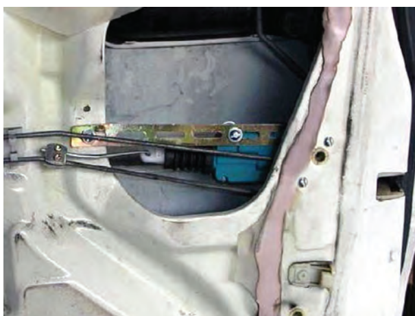
شکل ۲-۳۷- نحوه‌ی اتصال عملگر الکتریکی
