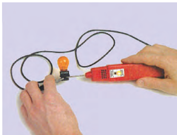
شکل ۱۸۲-۱- آزمایش لامپ چراغ راهنما
