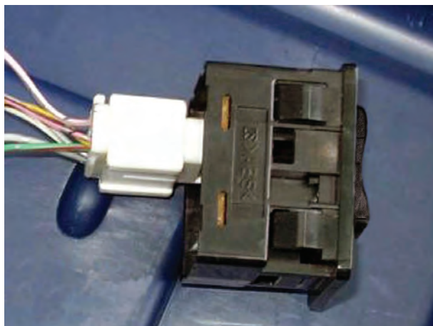
شکل ۱-۷۰- سوئیچ چراغ بزرگ جلو روی پانل
