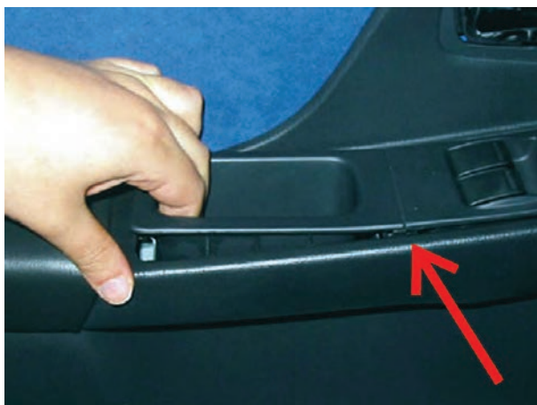
شکل ۱۸۳-۲ خارج نمودن قاب سوئیچ‌ها
