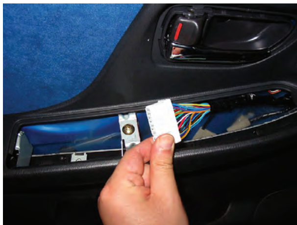
شکل ۱۸۵-۲ سوکت اتصال دسته سیم به سوئیچ‌ها
