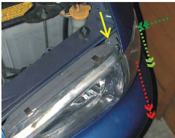
شکل ۱-۳۸- نحوه‌ی جدا کردن چراغ جانبی روشنایی
