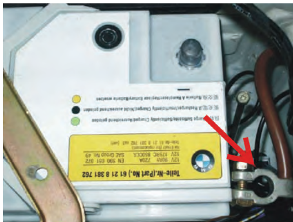
شکل ۲-۱۰۹- باز کردن اتصال منفی باتری
