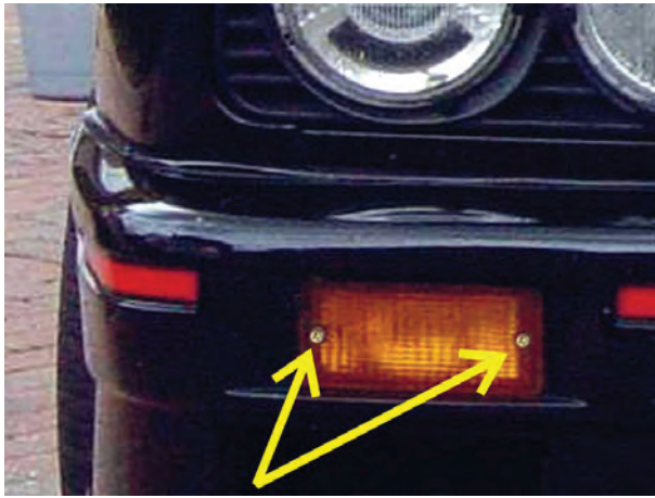
شکل ۱-۵۰ پیچ‌های اتصال تلق چراغ راهنما
