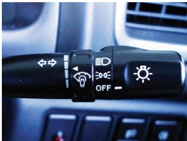
شکل ۱-۷۲- سوئیچ چراغ‌های روشنایی (طرح دسته‌ی راهنما)
