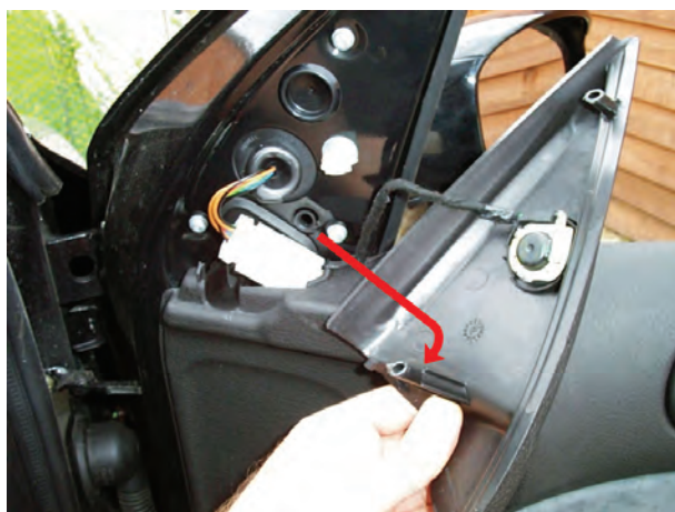
شکل ۱۶۵-۲ خارهای روی قاب و محل نصب آن
