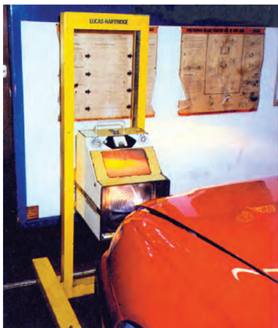
شکل ۱۵۳-۱- یک نوع دستگاه تنظیم نور چراغ‌های بزرگ
