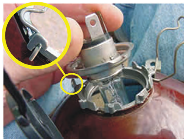
شکل ۱-۴۳- نحوه‌ی ثابت شدن لامپ درون کاسه‌ی چراغ
