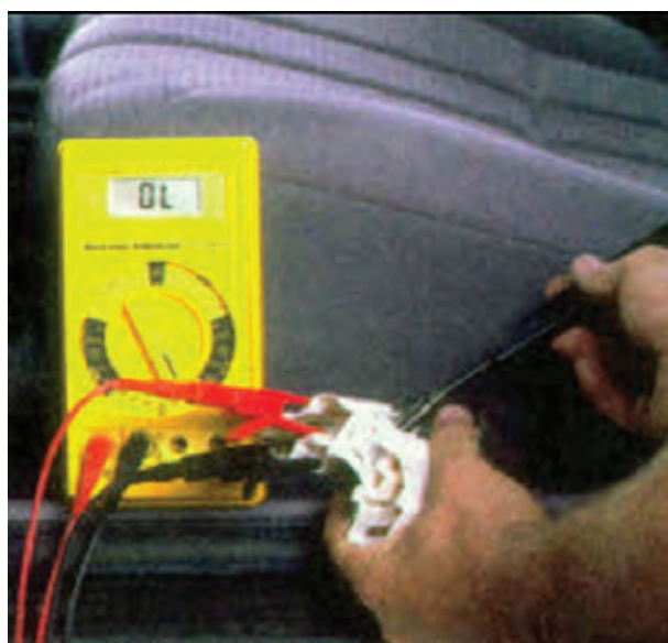
شکل ۹۸-۱- آزمایش حالت استپ موقت دسته ی راهنما
