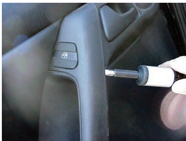
شکل ۲-۱۱۰- جدا کردن قاب سوئیچ شیشه بالابر
