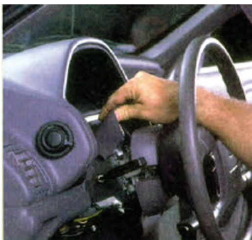
شکل ۹۱-۱- بیرون آوردن قاب سوئیچ روشنایی
