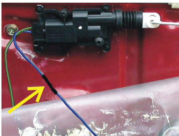
شکل ۲-۴۹- عایق کاری محل اتصال سیم ها به یکدیگر
