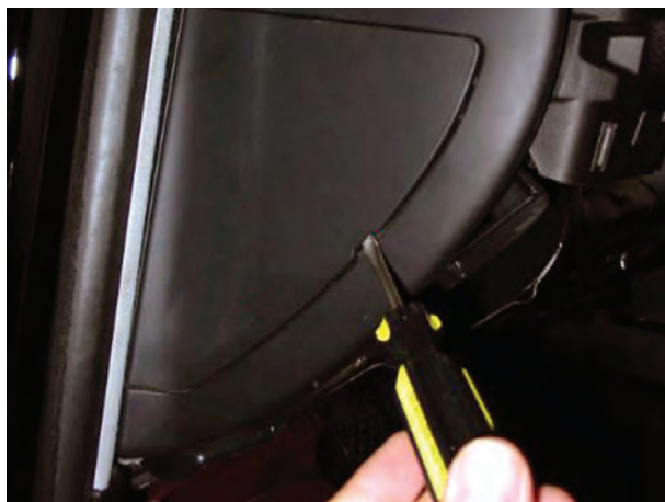
شکل ۱۱۸-۱ آزاد کردن خار پوشش محفظه‌ی جعبه‌ی فیوز
