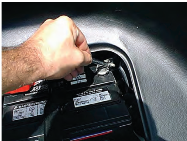
شکل ۱-۵۲ باز کردن بست ترمینال منفی باتری
