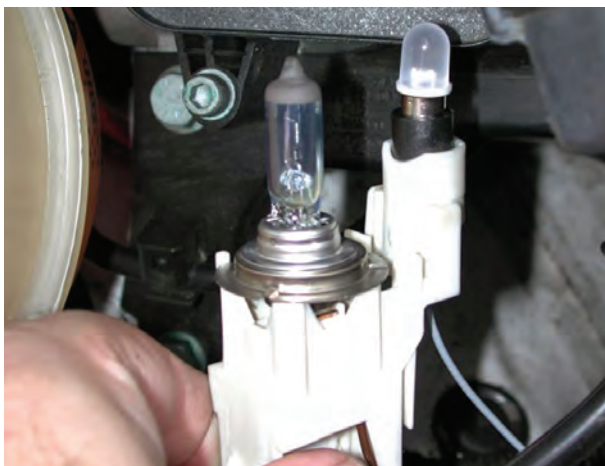
شکل ۱-۴۹ - پایه‌ی مشترک لامپ‌های چراغ روشنایی و پارک
