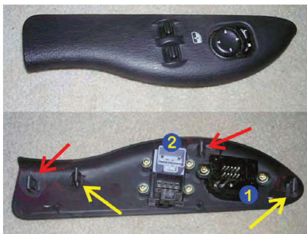
شکل ۱۸۱-۲ - قاب سوئیچ‌های روی پانل در سمت راننده در یک نوع خودرو
