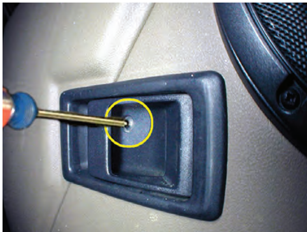
شکل ۲-۳۶- باز کردن قاب دستگیره‌ی قفل در
